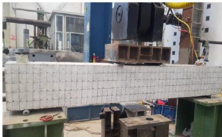
**Fig. 6.** fatigue test setup
